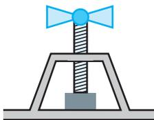
**Задача 3.2.** В винтовом прессе заготовка прижимается к опоре давящим штоком, который приводится в движение относительно рамы с помощью винта (см. рисунок). Шаг резьбы винта (расстояние между ближайшими бороздками) равен  $h$ . К рукоятке винта приложена пара сил, которая создаёт момент  $M$
