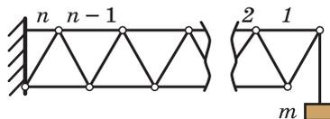
**Решение.** Рассмотрим равновесие части  $ABCD$  кронштейна (см. рисунок). Внешними силами для этой части являются сила натяжения нити, равная силе тяжести груза (сама конструкция по условию массы не имеет), и силы в двух шарнирах —  $A$  и  $B$ .
