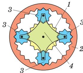
**Решение.** Планетарная передача работает таким образом, что вращение с центральной (солнечной) шестерни передаётся одновременно водилу и коронной шестерне, причём кинематическое распределение вращения между ними не определяется (недостаточно кинематических связей). Это позволяет в зависимости от момента торможения коронной шестерни и водила передавать им разное вращение.
