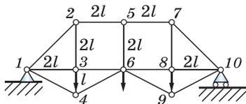
Имеется мостовая ферма пешеходного моста, слева опирающаяся на неподвижный шарнир, справа — на шарнирно-подвижную опору (см. рисунок). В шарнирах 3, 6, 8 к ферме приложены сосредоточенные силы  $F_1 = F_2 = F_3 = 20$  кН. Чему равны силы натяжения стержней 1—2 и 6—9? Весом самой фермы можно пренебречь. Геометрические параметры фермы показаны на рисунке.
