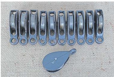
**Задача 3.7.** По чертежу Галилея (см. рисунок в синей рамке) сконструируйте полиспаст. Используйте блоки (см. рисунок слева), которые продаются в хозяйственных магазинах, и верёвку. Сначала оцените теоретически, а затем измерьте экспериментально выигрыш в силе, который обеспечивает данная конструкция. Рассчитайте также, насколько поднимется груз, если вытянуть верёвку на длину  $\Delta l$ .
