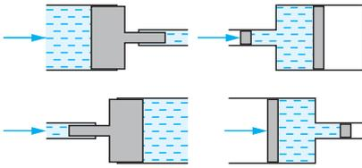
**Задача 8.3.** В гидравлических приводах используют узлы, схематически показанные на рисунках: на левых верхнем и нижнем рисунках поршень переменного сечения разделяет две жидкости, на правых верхнем и нижнем жидкость в трубе переменного сечения занимает пространство
