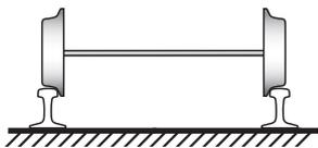
**Задача 5.4.** Известно, что железнодорожные рельсы делают выпуклыми, колёса поезда насажены на одну ось (колёсная пара) и имеют коническую форму, причём их внутренний диаметр больше внешнего (см. рисунок). Объясните, зачем это делается.
