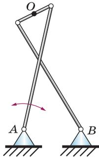
**5.5.** Рассмотрите устройство, которое называется механизмом Чебышёва. Оно состоит из двух длинных стержней и одного короткого (см. рисунок). Пусть левый стержень совершает повороты вокруг точки  $A$ . Как при этом движется середина  $O$  короткого стержня? Соберите механизм Чебышёва из конструктора с болтами и гайками. Проверьте, как работает механизм. Напишите программу, позволяющую проследить за движением механизма.
